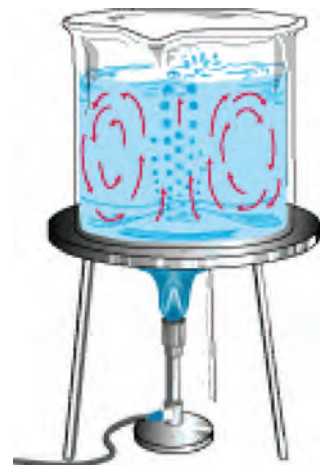
Sumber: http://pubs.usgs.gov/ Gambar 5.27. Proses konveksi pada air yang dipanaskan
