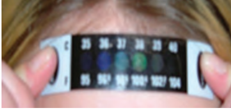
Sumber: www.flickr.com Gambar 4.8 Termometer kristal cair untuk mengukur suhu tubuh.
