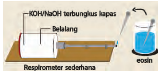
Sumber: Dok. Kemdikbud Gambar 5.24 Respirometer sederhana
