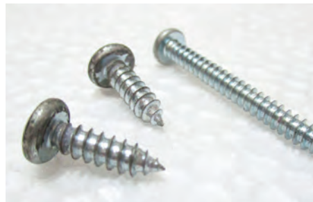
Gambar 2.5 Contoh Bidang Miring: Sekrup
