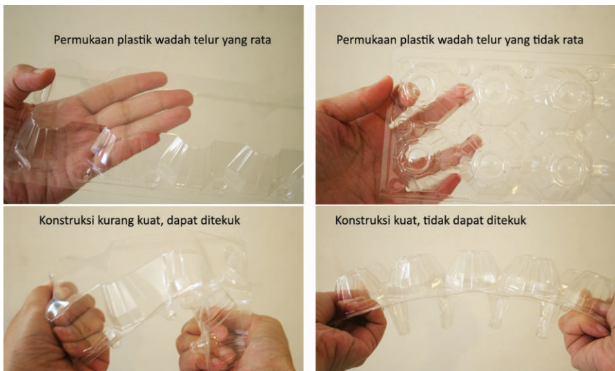
Gambar 5.8 Perbandingan Kekuatan Konstruksi Plastik Wadah Telur
